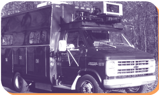
นาฟแล็บวัน (NavLab 1) รถยนต์ขับเคลื่อนอัตโนมัติคันแรกของโลก ได้รับการพัฒนาใน ค.ศ. 1984
